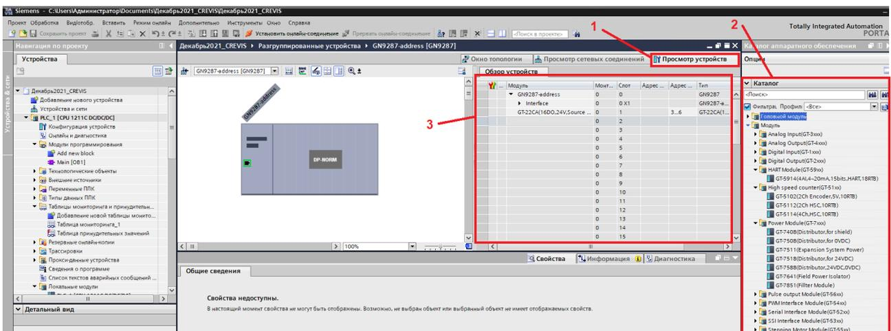
Назначить IP-адрес и PROFINET имя адаптеру CREVIS можно в меню «GN9287-address» (имя устройства в проекте) - «Онлайн и диагностика» в соответствующей вкладке.
