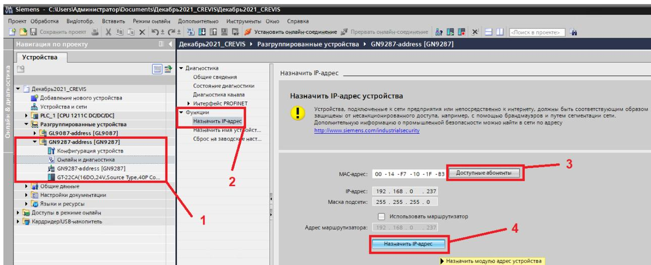
**Примечание.** Назначение PROFINET имени адаптеру CREVIS возможно только при положении **ON** соответствующего DIP-переключателя (DIP №10).
